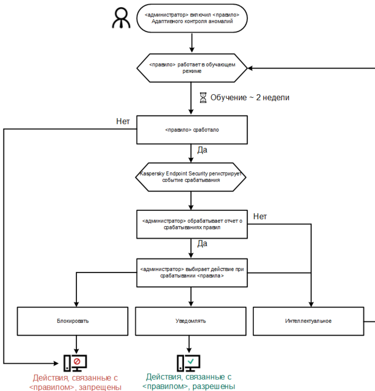
Рисунок 82. Алгоритм работы Адаптивного контроля аномалий
